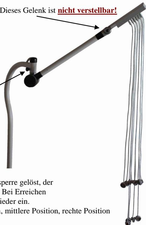
Durch Herausziehen des Rastbolzens wird die Schwenksperre gelöst, der Ausleger des Arms kann horizontal geschwenkt werden. Bei Erreichen der nächsten Rastposition rastet der Bolzen selbsttätig wieder ein. Es gibt drei Rastpositionen des Auslegers: linke Position, mittlere Position, rechte Position
