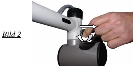
Um die Einstellung des Rastbolzens zu verändern muss der Rastbolzen herausgezogen und um 30° gedreht werden! (jeweils nach links oder rechts möglich)
